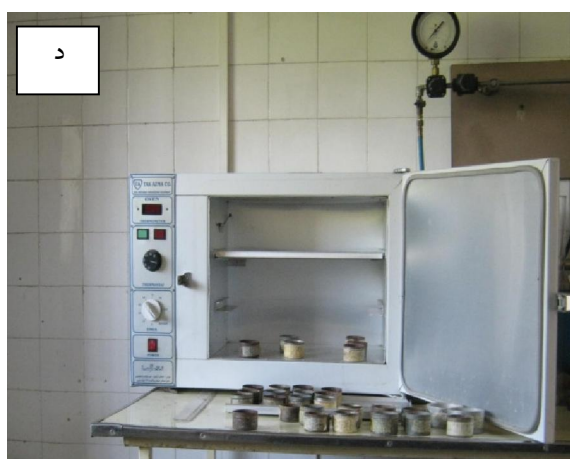
شکل ۲- نمونه‌برداری از خاک با مته، توزین تین‌ها و نحوه خشک کردن نمونه‌ها
