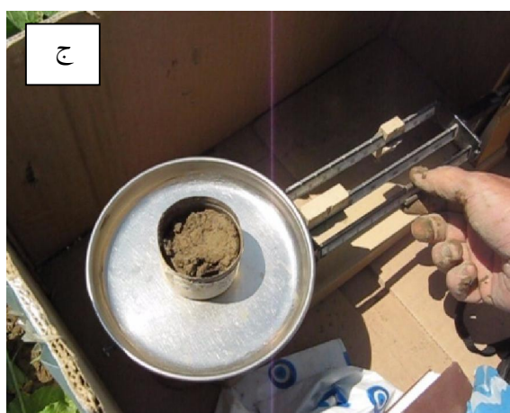
شکل ۲- نمونه‌برداری از خاک با مته، توزین تین‌ها و نحوه خشک کردن نمونه‌ها
