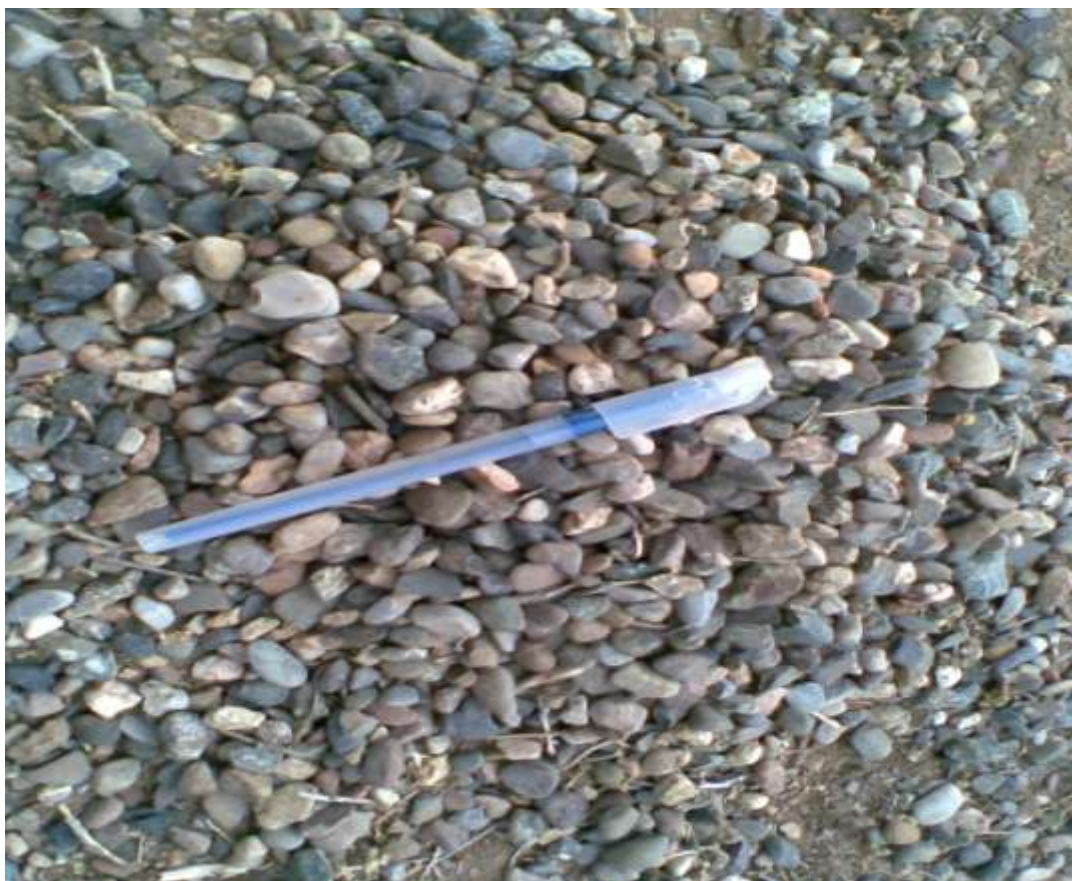
شکل ۶- ۱: گراول استفاده شده در چاههای آب منطقه (۸۸/۶/۹)
