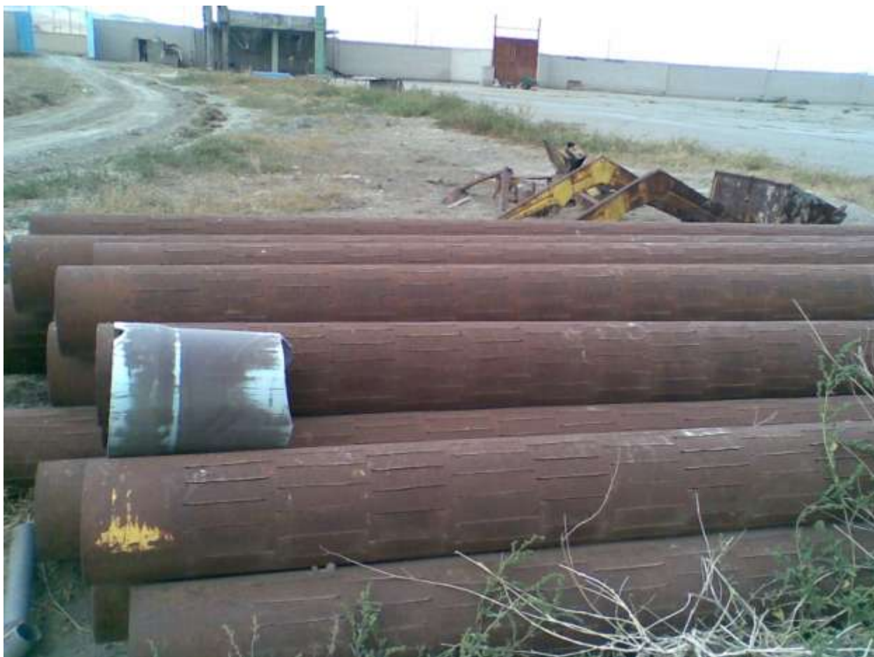
شکل ۳ - ۴: لوله جدار مشبک فولادی معمولی که در چاههای آب منطقه بسیار رایج می باشد (۸۷/۶/۹)
