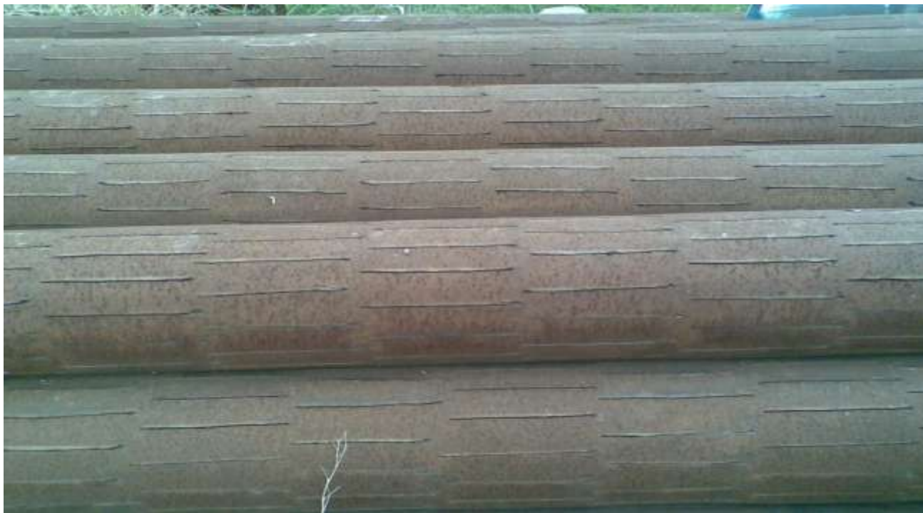
شکل ۳ - ۱: تصویری از لوله های مشبک فولادی که توسط شعله هوا سوراخ شده اند (۸۷/۶/۹)
